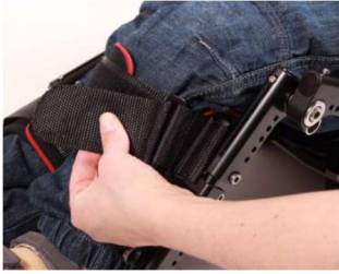
Rys. 12 Zapięcie peloty kolanowej
