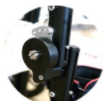
Utrzymanie pozycji stojącej dzięki systemowi dynamicznego rozciągania kolana
